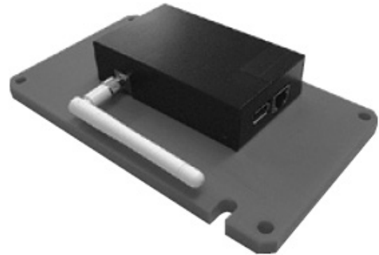
Fig. 4 Wireless LAN Unit
