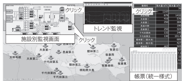
(a) 広域監視サービス(全体画面)
