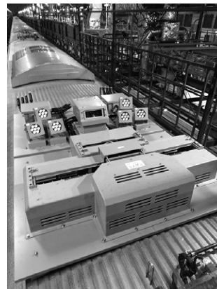
第7図 9号車 架線検測装置
