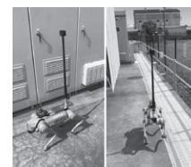
(b) 変電設備内を走行する四足歩行ロボット
