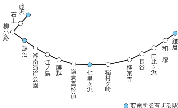
第1図 路線図と変電所の配置
