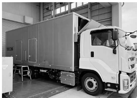
第7図 高圧移動電源車
