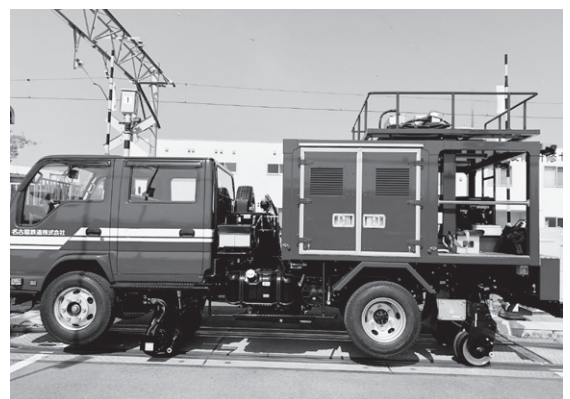
第 8 図 軌陸車に搭載した架線検測装置
