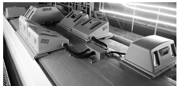
第6図 電車線金具モニタリング装置
