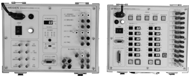
第12図 発電機動特性試験器操作パネル
