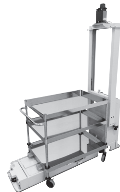
第 6 図 VC組み立て用資材搬送AGV
