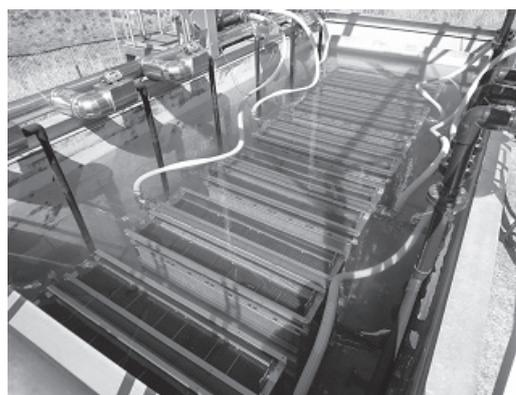
第8図 セラミック平膜浸漬形膜ろ過装置
