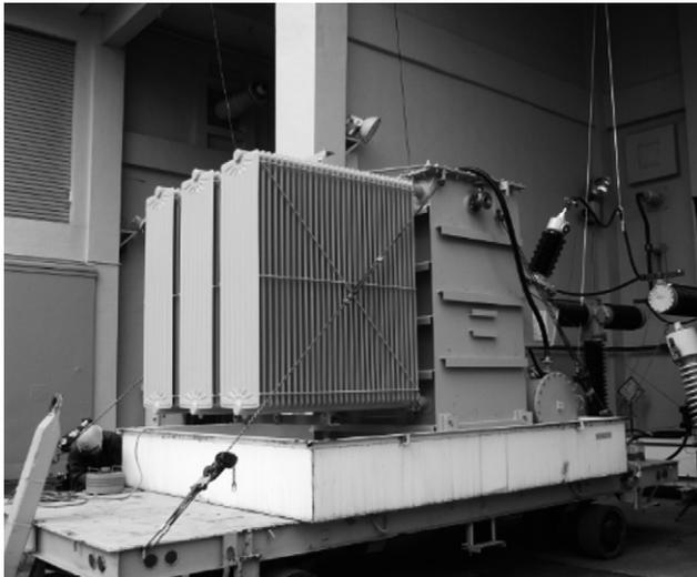
第3図 短絡試験状況
