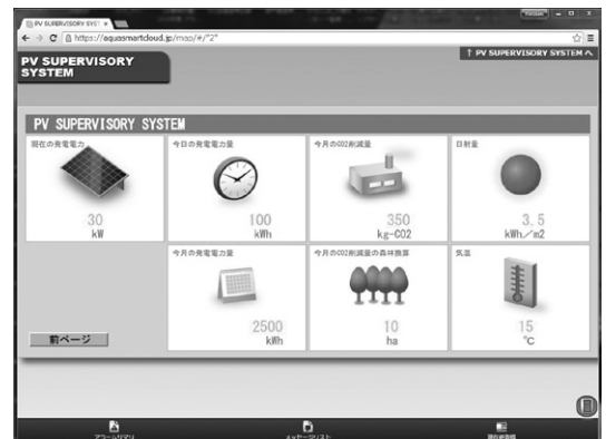
第 2 図 太陽光発電状態監視画面
