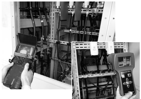
第5図 紫外線測定器（上）と超音波測定器（下）
