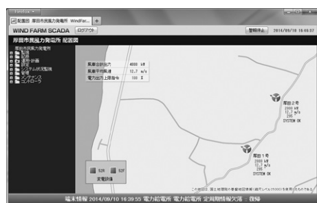
第25図 SCADAシステムの画面表示例
