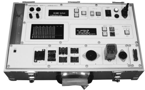
第5図 補助リレー接触抵抗測定器
