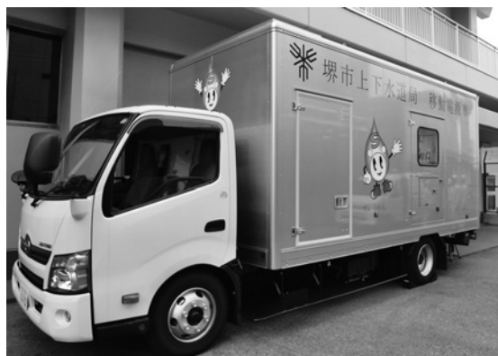
第3図 625kVA移動電源車
