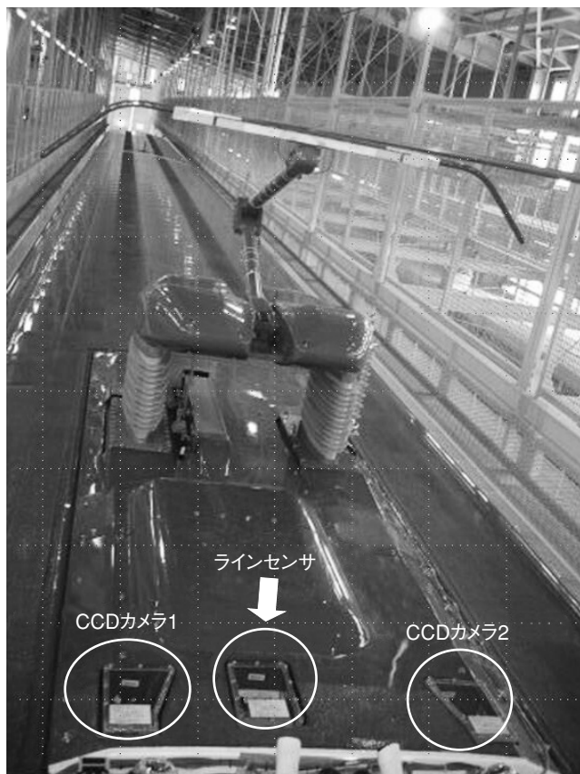
第5図 架線検測装置のカメラ配置 屋根上に設置したカメラが電車のパンタグラフを斜めに見上げるカメラ配置になっている。
