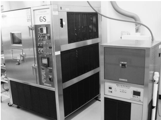
第1図 ガス腐食加速試験装置
