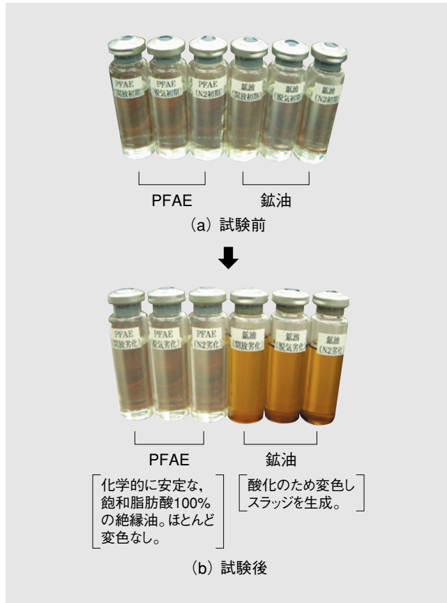
第3図 酸化安定性試験結果 (JIS C 2101 : 120°C × 75H)
