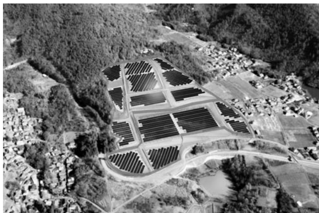
第4図 やまなしメガソーラー（甲斐）（仮称） 三井物産(株)，東京海上アセットマネジメント投信(株)との年金ファンドによる発電事業にEPCとして参画している5.1MWのメガソーラー計画図を示す。
