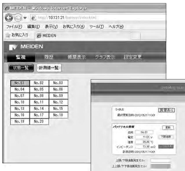
第3図 状態一覧画面 ESW-100Bのバッテリー設備全体の状態一覧画面を示す。
