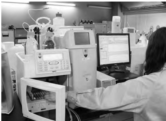
第5図 イオンクロマトグラフ分析装置 冷却水中の腐食成分を含むイオン成分濃度を分析する装置を示す。
