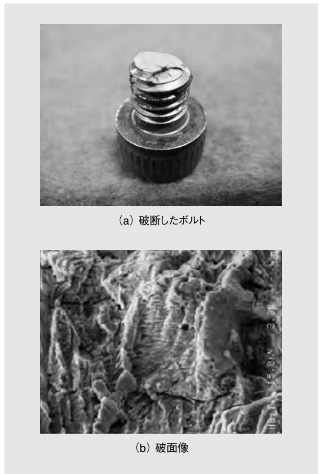
第12図 破断したボルトと破面像 破断したボルトと破面を電子顕微鏡で拡大観察した像を示す。疲労破壊により生じる縞模様（ストライエーション）が確認できる。
