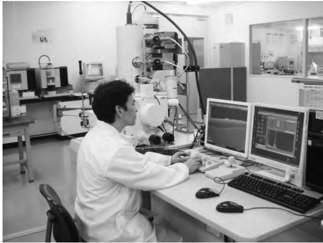
第9図 分析機能付き電子顕微鏡 元素分析や分布解析機能を備えた電子顕微鏡の測定時の様子を示す。
