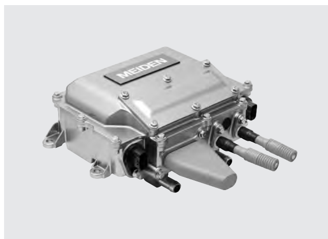
第9図 電気自動車用標準コントローラ 大幅な小形・軽量化を実現した。
