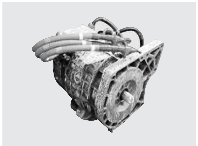
第7図 塩水噴霧試験 塩水噴霧試験の様子を示す。
