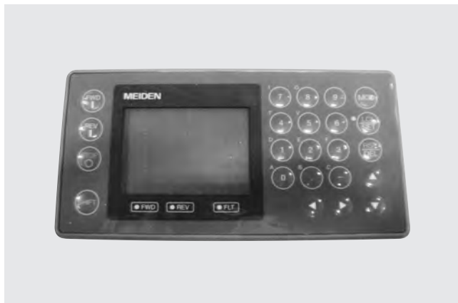
第5図 オペレーションパネル 大形ディスプレイ（5行表示）とテンキーを備え操作性を向上している。
