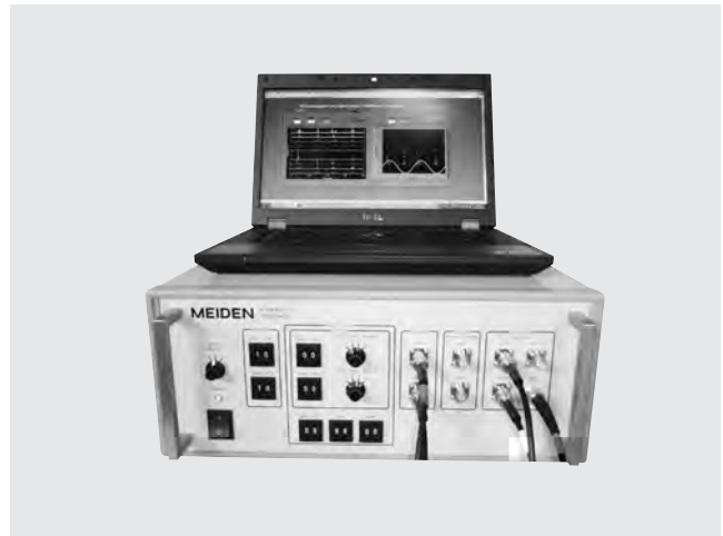
第1図 部分放電測定装置
