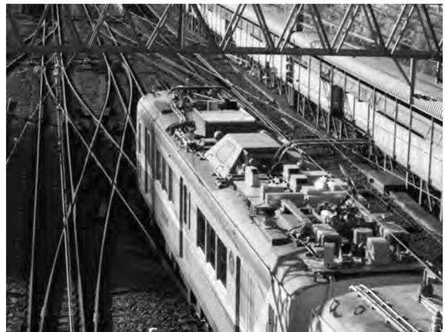
第21図 当社架線検測装置を取り付けた電気検測車
