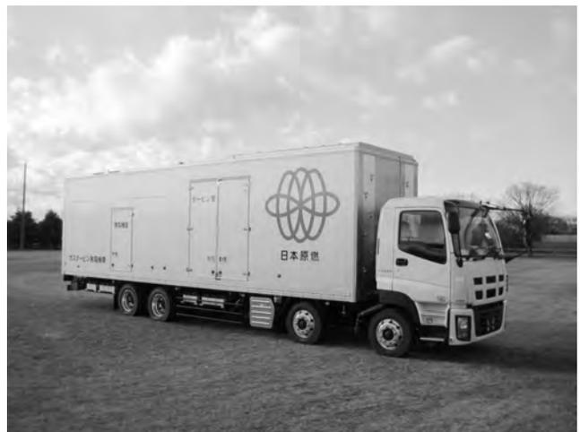
第2図 2000kVAガスタービン移動電源車
