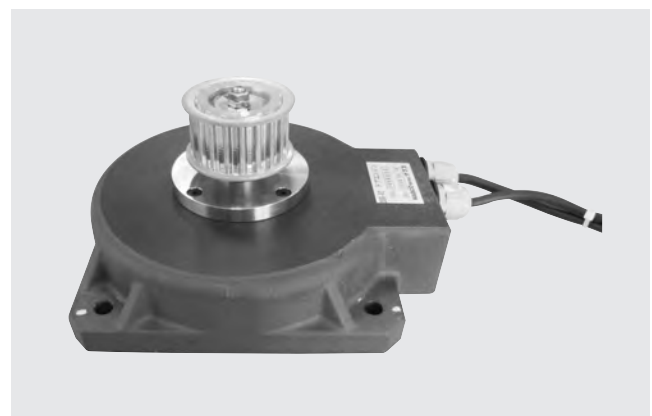
第6図 自動ドア用モータ 135W-260min -1 電車の自動ドア用モータの外観を示す。設置スペースが狭いため、偏平形で低速大トルク化を実現し、ドアへの適用を可能にした(外形φ160mm)。
