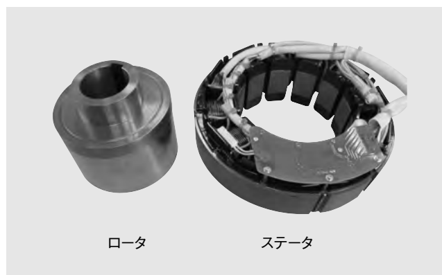
第2図 真空ポンプ用モータ 7.5kW-6400min -1 7.5kWモータの外観を示す。ロータとステータのビルトイン構造としており、小形化（外径φ210mm）・高効率化を実現した。
