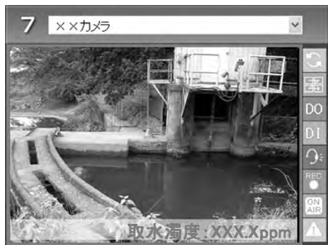
第6図 画像監視画面例 カメラ映像とセンサとの情報を組み合わせ表示し、異常発生時は強調表示する。
