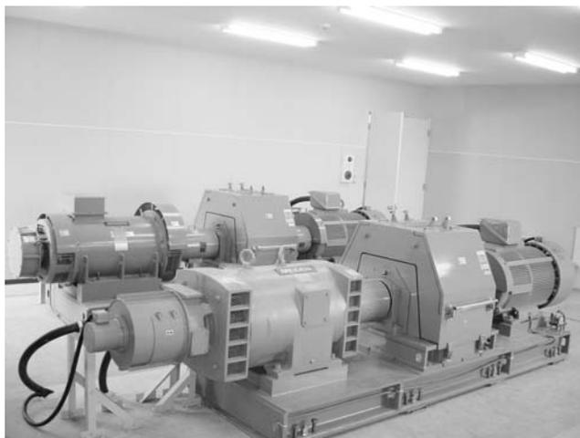
第1図 風力発電機模擬装置
