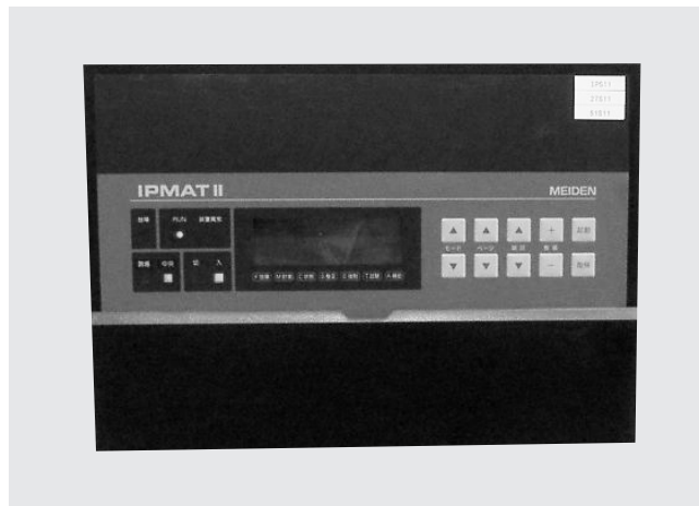
第3図 多機能形デジタル継電器 今回納入した多機能形デジタル継電器を示す。
