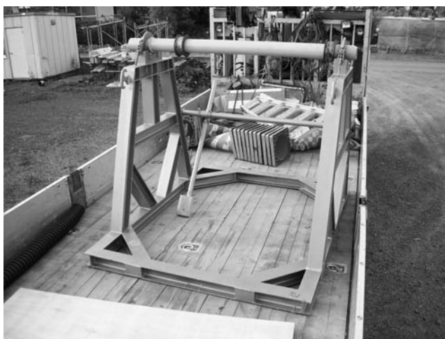
第7図 ケーブルドラムジャッキ 今回工事にケーブルドラムジャッキを製作した。
