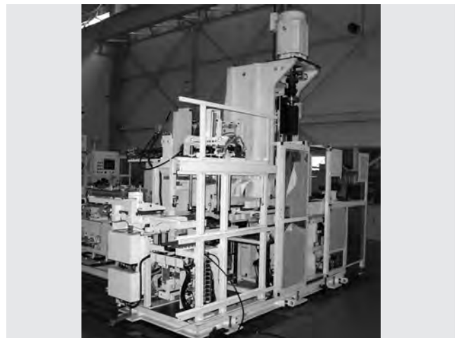
第21図 大形トルクコンバータ用テスト
