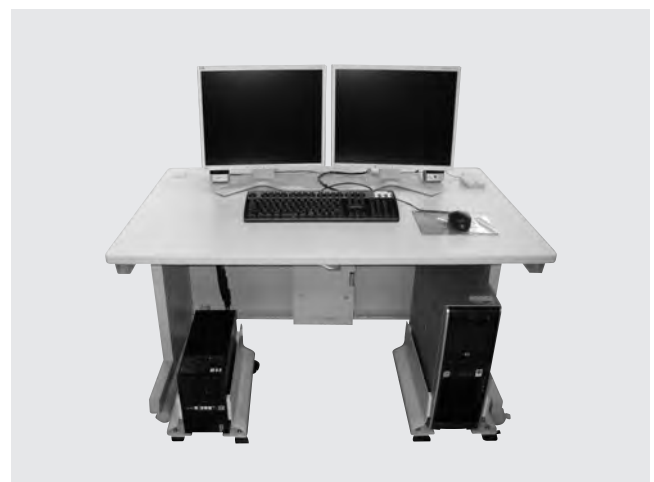
第15図 配電総合自動化システム (操作卓)
