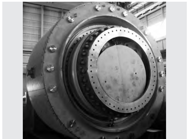
第2図 風力用永久磁石同期発電機 (PMG)
