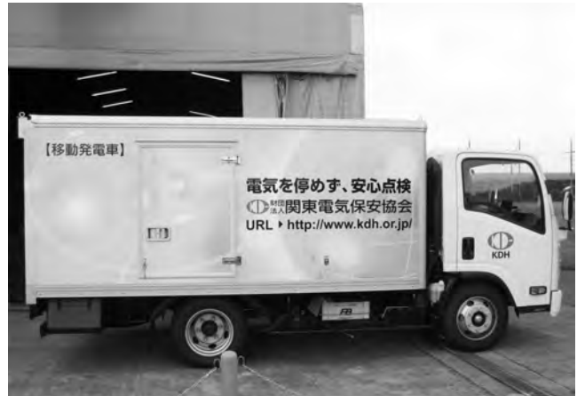
第1図 75kVA低圧移動発電車
