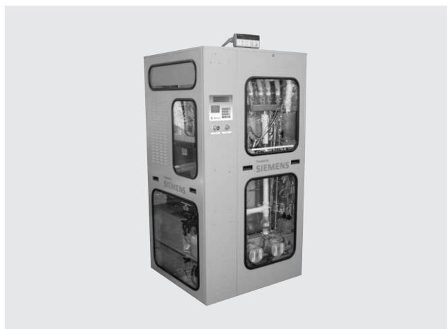
第6図 5kW級固体酸化物形燃料電池
