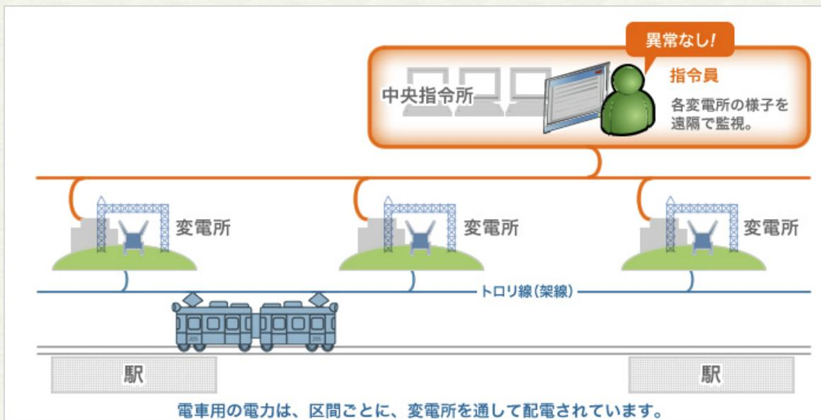
▲中央指令所～変電設備～電車 模式図
