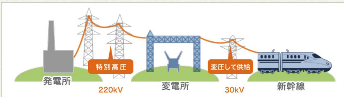
▲発電所から電車までの電気の流れ（新幹線の例）
