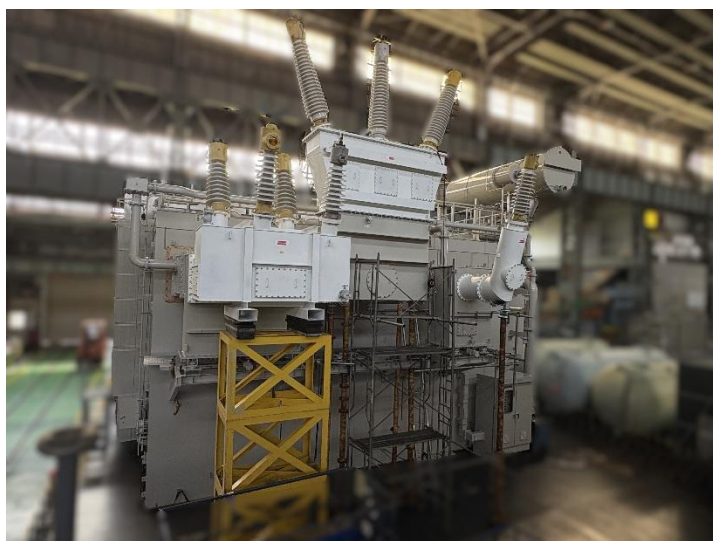
パームヤシ油入 154kV 200MVA 導油風冷式変圧器
