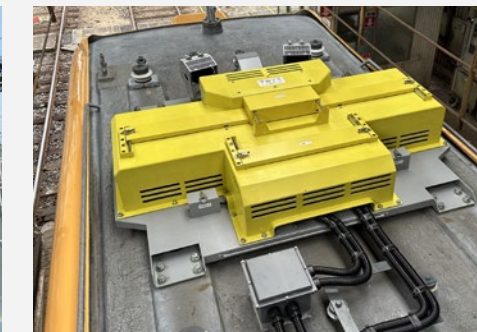
クラウド対応カテナリーアイ (架線検測システム)
