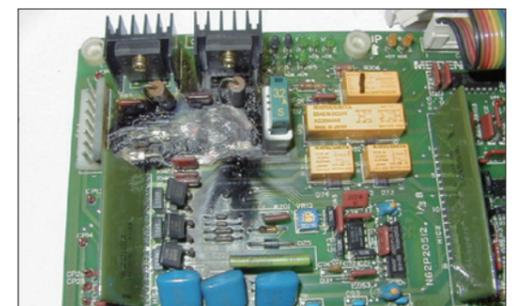
プリント板の焼損(コンデンサ液漏れ)
