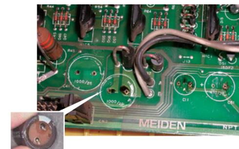
プリント板電解コンデンサ液漏れ(部品寿命)
