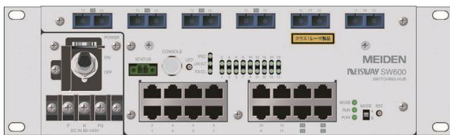
DC電源入力 (TYPE3)、100BASE-FX (SCコネクタ) 6ポート型 正面図
