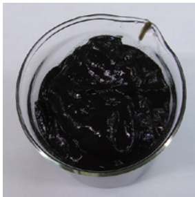
濃縮消化汚泥
