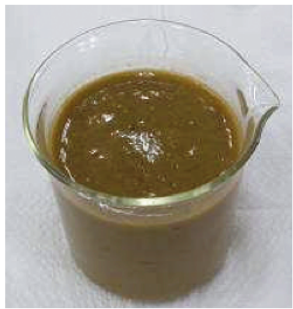
濃縮余剰汚泥
