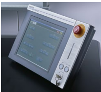
操作BOX MDOP-2101 タッチパネル:12.1型 キースイッチ:操作ロック 非常停止スイッチ:照光式
