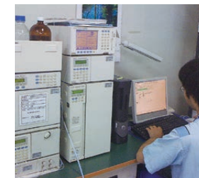
油入変圧器の余寿命診断 【分析センター】
