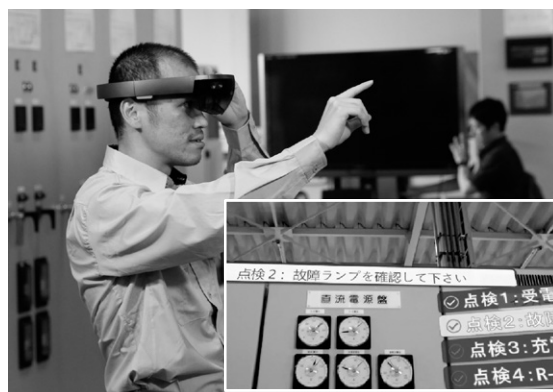
第7図 3DアイウェアによるAR点検
