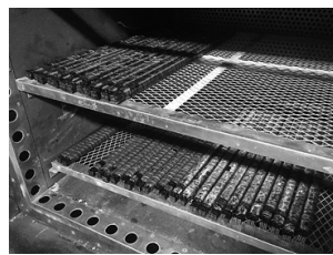
(c) コイルエンドモデル熱劣化試験
