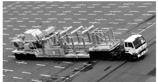
第6図 イラク電力省向け移動式変電設備 3)
