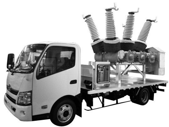
第4図 移動用タンク形VCB
