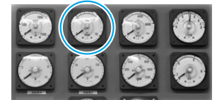
(d) ネットワークカメラで撮影した発電出力メータ画像からアナログ値をデジタル化
