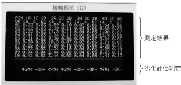
第2図 接触抵抗結果及び評価判定例
