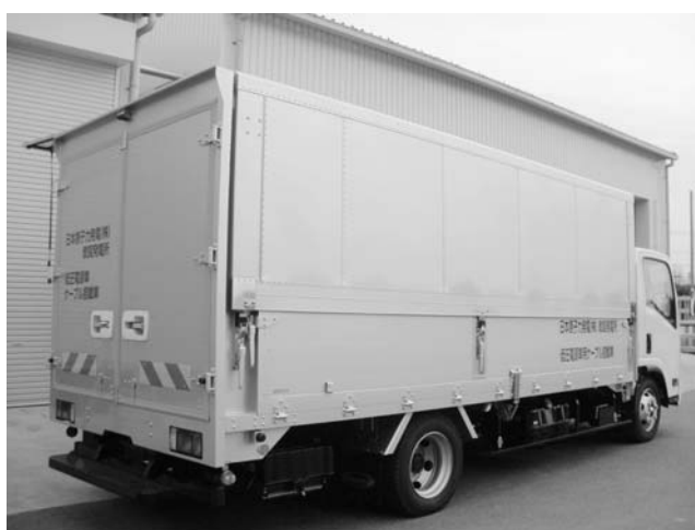
第14図 低圧電源車用ケーブル搭載車
